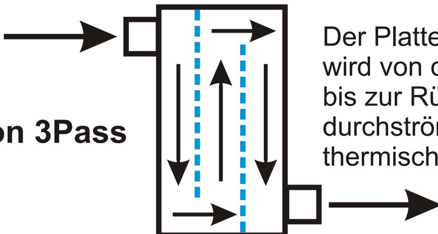
Der Plattenwärmetauscher wird von der Vorlaufseite bis zur Rücklaufseite 3x durchströmt (3-fach thermische Länge)
