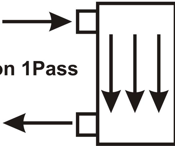
Der Plattenwärmetauscher wird von der Vorlaufseite bis zur Rücklaufseite 1x durchströmt (Standard)
