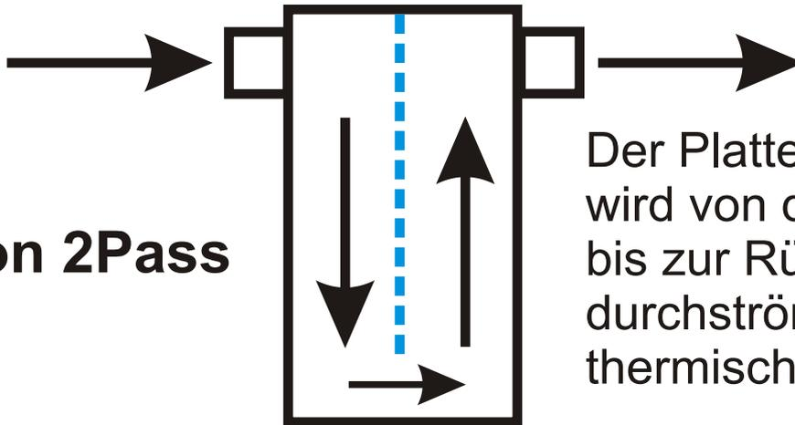
Der Plattenwärmetauscher wird von der Vorlaufseite bis zur Rücklaufseite 2x durchströmt (2-fach thermische Länge)
